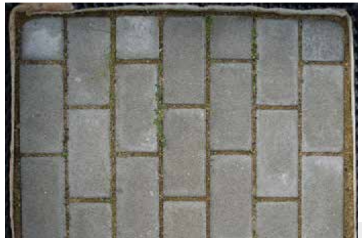
Bild 5: Auch Mainsand bot im gealterten Zustand und unter feuchten Bedingungen gute Keimbedingungen (Aufnahme 01.07.2010 = 56. Versuchstag, Palette 7).
